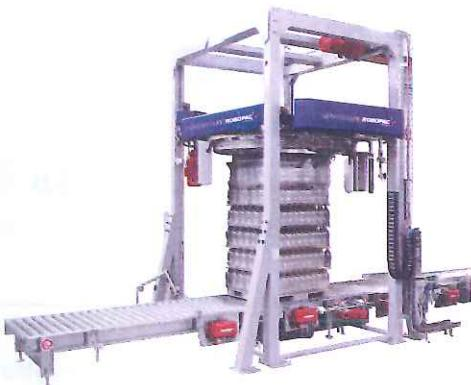
На базе палетообмотчиков наша компания внедрила новую технологию растяжения пленки с наименованием Cube. Новизна заключается в особо точном управлении предрастяжением и в контроле натяжения пленки по углам, а также в возможности программировать вариативный цикл. То есть заказчик, с одной стороны, может работать на предельном престрайче (400% и выше) без риска обрыва пленки, а с другой стороны, может перераспределить
